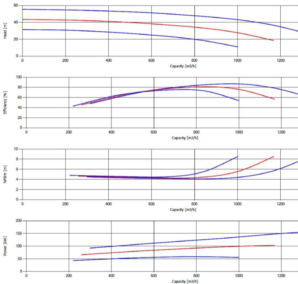
\* مقادیر ارتفاع و توان برای دانسیته  $\rho=1 \text{ kg/dm}^3$  و گرانروی سینماتیک  $r=20\text{mm}/\text{s}$  می باشد.
